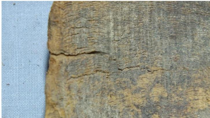
**Foto 11 Agrietamiento y fisuras producto de la descohesión en la madera.**
