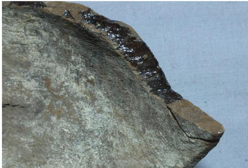
**Foto 27 Detalle de adhesivo residual en punto de contacto.**
